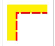
Выпуклость за контур реза. Выведите за контур реза на 3 мм фон и
